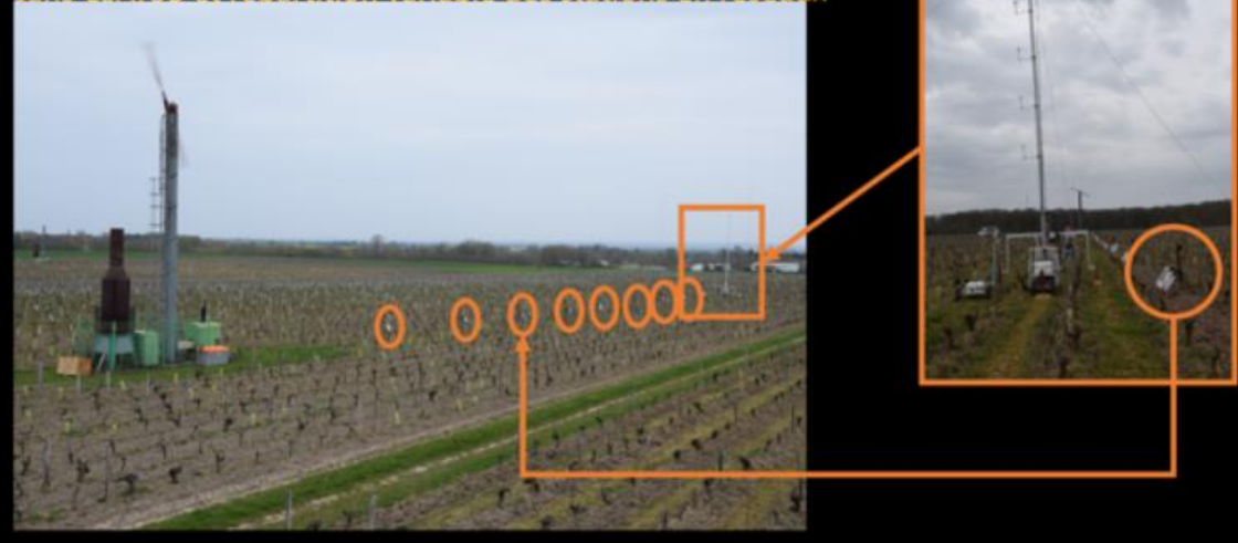
Protocole 3 : Quasi identique au protocole 2, mais statique, sans CSAT3B et répartition variable des stations en réseaux
